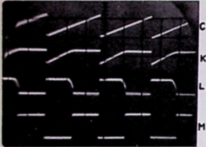
Afb. 7. Zaagtand-vierkant transformatie. Tijdbasis: 1 ms/verdeling. C en M ware grootte, K 5 x versterkt, L 2 x versterkt.
