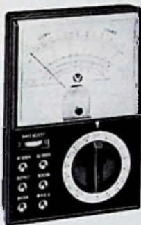
G.23 30.000 ohm/volt Universeelmeter, een kwaliteits meetinstrument. DC Volt: 0-0,6; 3; 15; 60; 300; 600; 1.200 (30.000 opv). AC Volt: 0-6; 30; 120; 600; 1.200 (15.000 opv) DC stroom: 0-30 \mu A; 3 mA; 30 mA; 600 mA. Weerstand: 0-8 K, 80 K, 800 K, 8 Meg. Decibel: -20 - +17
