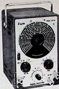
SG.70 Meetzender, d.m.v. verwisselbare kristallen zóór nauwkeurige ijkmogelijkheid. Freq.ber. 120 kHz-130 MHz, 100-500 MHz (harmonisch)
