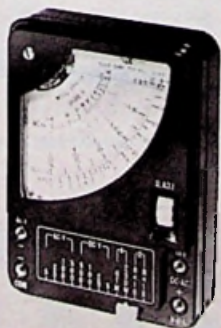
EP.10K 10.000 ohm/volt Universeelmeter, met een handige schuifschakelaar waarmee u rechtstreeks alle meetbereiken kunt instellen. DC Volt: 5; 25; 100; 500; 1000 (10.000 opv) AC Volt: 5; 25; 100; 500; 1000 (10.000 opv) DC stroom: 100 \mu A (250 mA) Weerstand: 30 K, 3 Meg. Decibel: -20 - +15 db.
