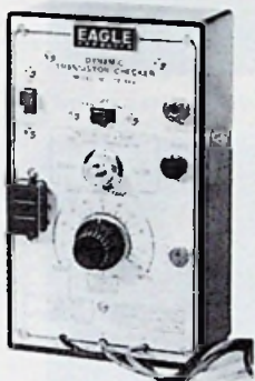
TT.144 Dynamic transistortester, waarmee u op eenvoudige wijze type PNP en NPN transistors kunt testen.
